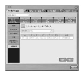
SHR-2040/2041/2042本体にRemote Control Deviceを装着して、設定をアクティブにしておけばビュ ーアーではPTZコントロールができなくなります。
